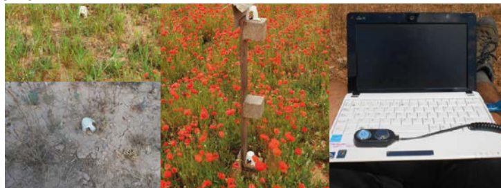
Figura 12.12. Sensors de temperatura iButton DS1922L instal·lats a nivell de sòl (esquerra), i a 20 cm i 1 m (centre). Procés de lectura de les dades (dreta).
