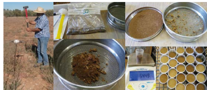
Figura 12.14. Procés d'obtenció i processament de les mostres de sòl per tal de determinar-ne la humitat.
