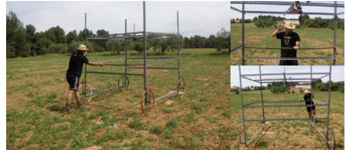
Figura 12.17. Estructura utilitzada per a l'obtenció d'imatges zenitals dels plots sempre des de la mateixa posició i sense provocar cap mena de pertorbació en els plots.
