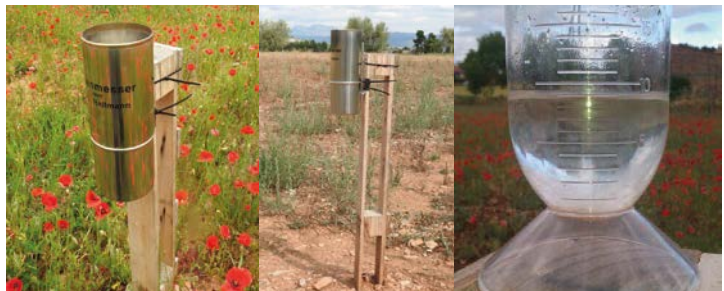
Figura 12.11. Pluviòmetre Hellman 120 instal·lat en els cultius i emprat per la monitorització de les precipitacions.
