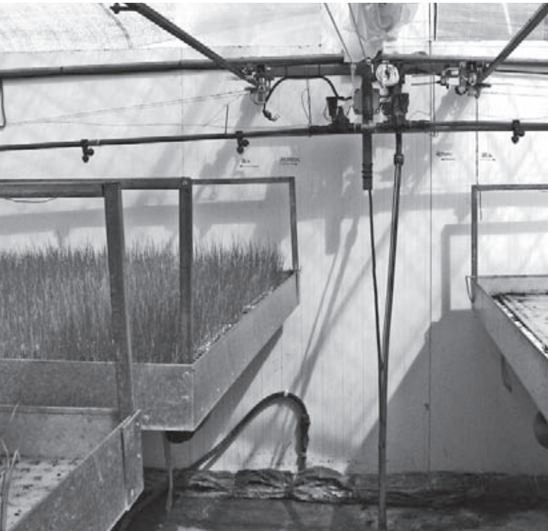
Els carros de reg són el sistema més utilitzat en la producció comercial de planters, ja que és el que garanteix el reg més uniforme. A la foto, instal·lació de la Fundació Onyar - La Selva.
