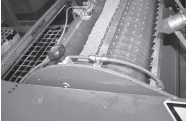
Les màquines de sembrar incorporen mecanismes que permeten una gran automatització d'aquest procés, des de l'alimentació del substrat i les safates, fins a la sortida de la safata amb la llavor sembrada, coberta i remullada.
